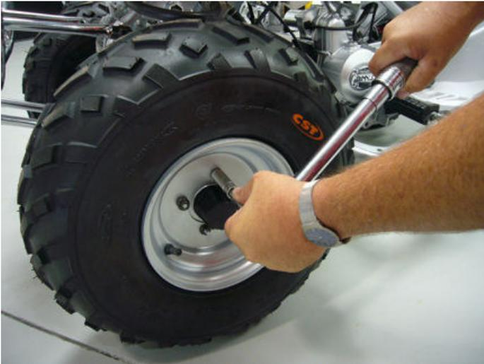
step07-fig1-Final lug nut torque
