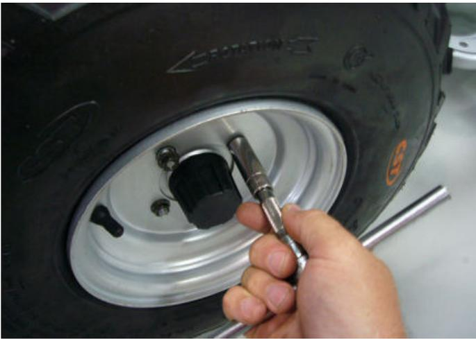
step05-fig2-Hand tighten lug nuts
