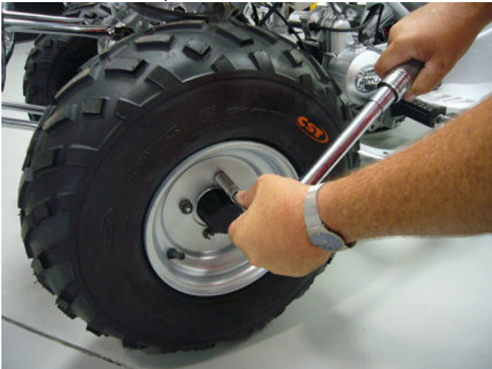
step07-fig1-Final lug nut torque
